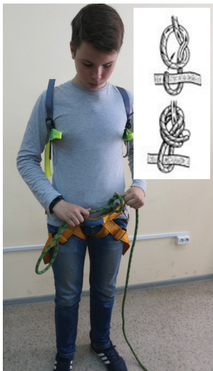
10. Отмерив короткий конец веревки (около 1 м), достаточный для уса самостраховки, встречным узлом крепим его к поясу беседки, под коушем.
