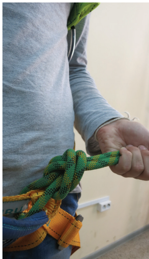
11. Расположение узла блокировки обеспечивает его надежную фиксацию на поясе беседки и освобождает коуш для дальнейшей работы.
