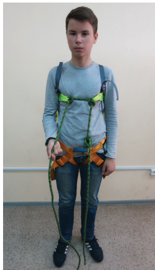
12. Пропускаем длинный конец блокировки через коуши грудной обвязки, фиксируя коуши дополнительными узлами, исключающими проскальзывание.
